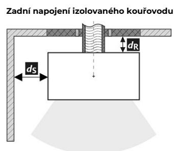
Prostup kouřovodu stěnou z hořlavé hmoty ČSN 06 1008
